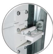
Elementos de herraje, bisagras y portar rodillo en acero galvanizado, junto con rodillo de nylon y acero.
