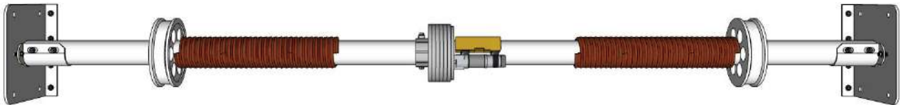
Motor centro de eje con poleas de nylon y muelles
